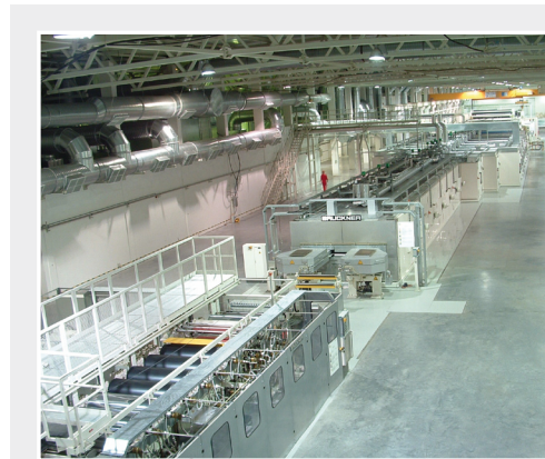
Moderne Folien-Reckanlage von Brückner
